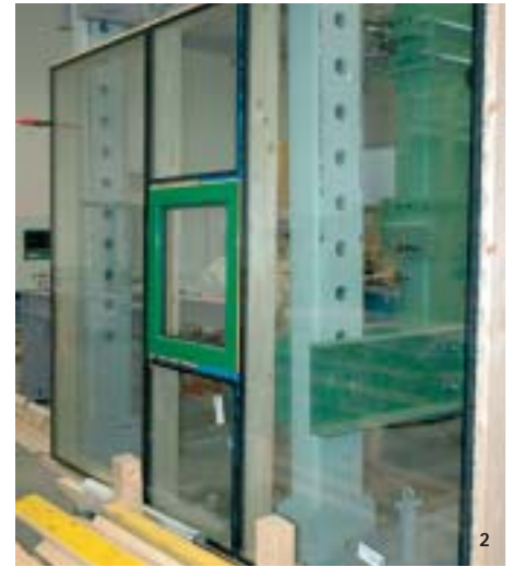
1 und 2 Konstruktionsprinzip des Holz-Glas-Verbundelementes und erste Versuche damit als Fassadensystem am Bauteilprüfstand
