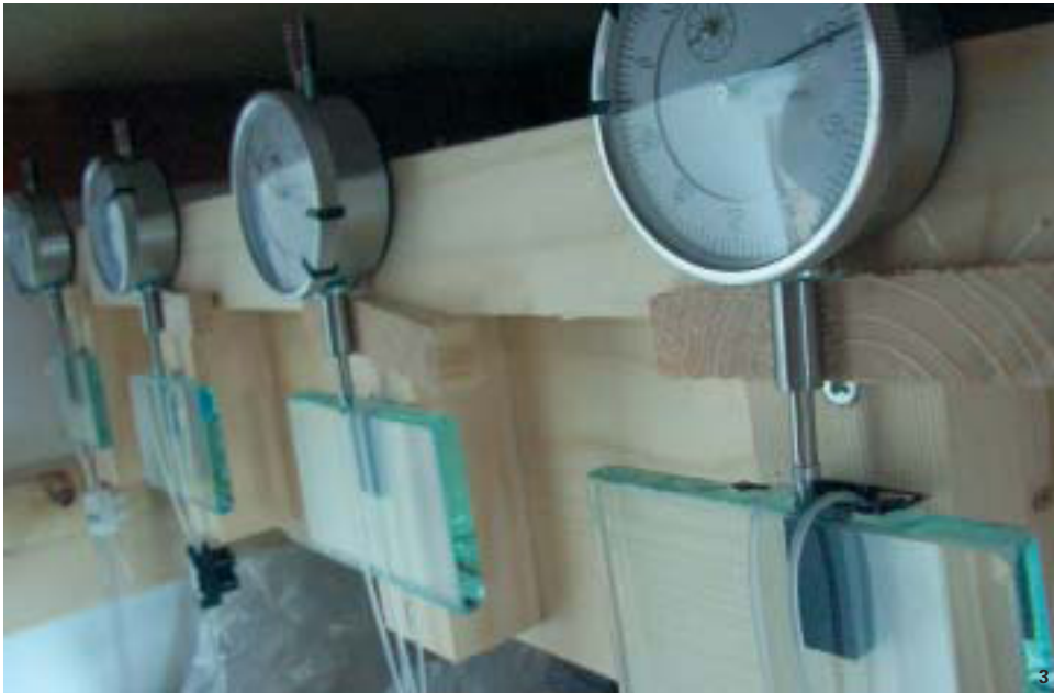
3 Untersuchung des Kriechverhaltens der elastischen Klebstoffe
