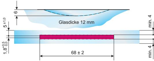
14.1.2. *Lagetoleranz Kantensegmenteinschliffe: ± 3 mm*
