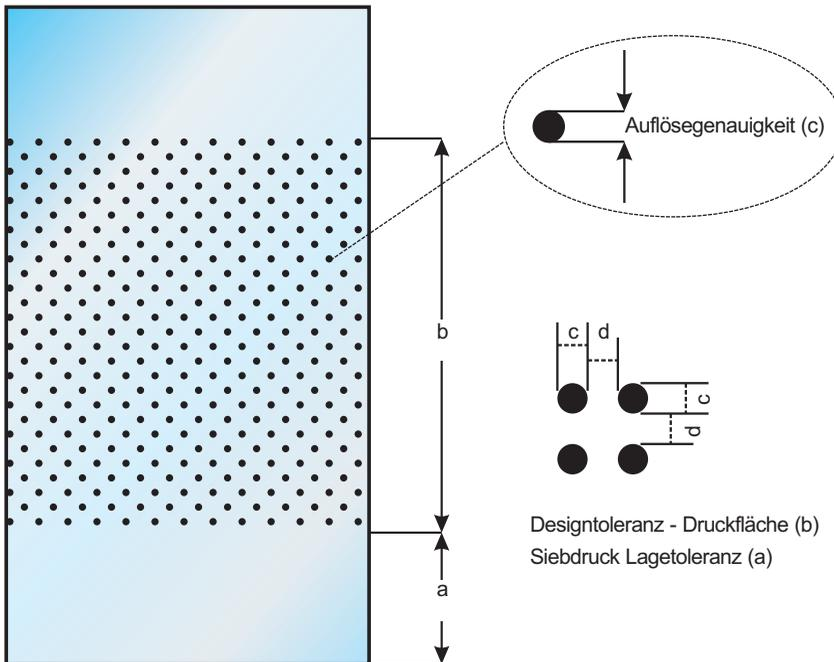
Abb. 16 zu Tab. 21: Fehlerarten/Toleranzen für siebbedruckte Gläser
